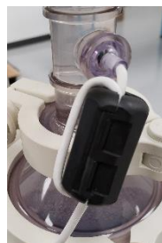
Figuur 3. Geïnstalleerde ferrietkraal voor druksensor in het stromingssysteem
